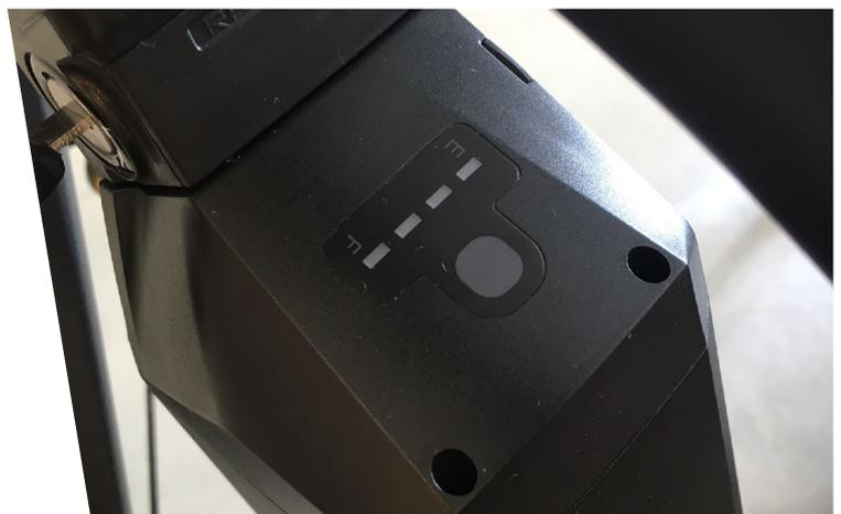
Der Akku kann aus dem Elektrofahrrad entnommen werden. Um den Akku zu entnehmen, drehen Sie den Schlüssel und ziehen den Akku am oberen Ende nach links heraus. **ACHTEN SIE AUF SEIN GEWICHT.**
