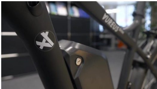
Batterie am Power45 montiert
