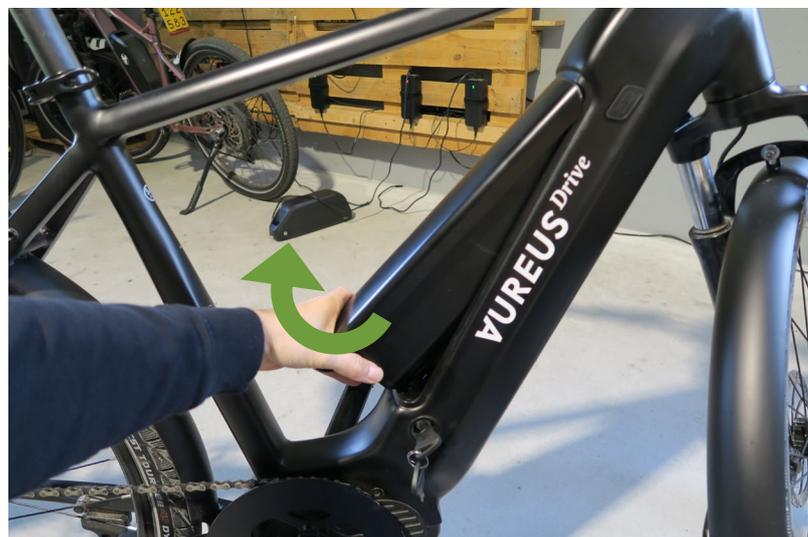
Der Akku kann aus dem Elektrofahrrad entnommen werden. Um den Akku zu entnehmen, drehen Sie den Schlüssel und ziehen den Akku am unteren Ende nach links heraus. **ACHTEN SIE AUF SEIN GEWICHT.**
